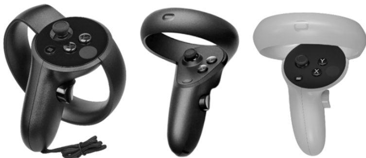
Рис. 2.31. Внешний вид контроллеров Oculus Touch (Rift S, Quest, Quest2)
