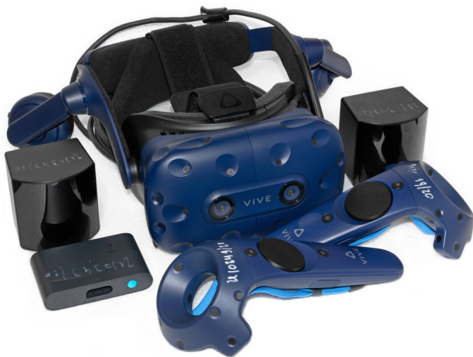
Рис. 2.1. Основные компоненты VR-системы VIVE Pro
